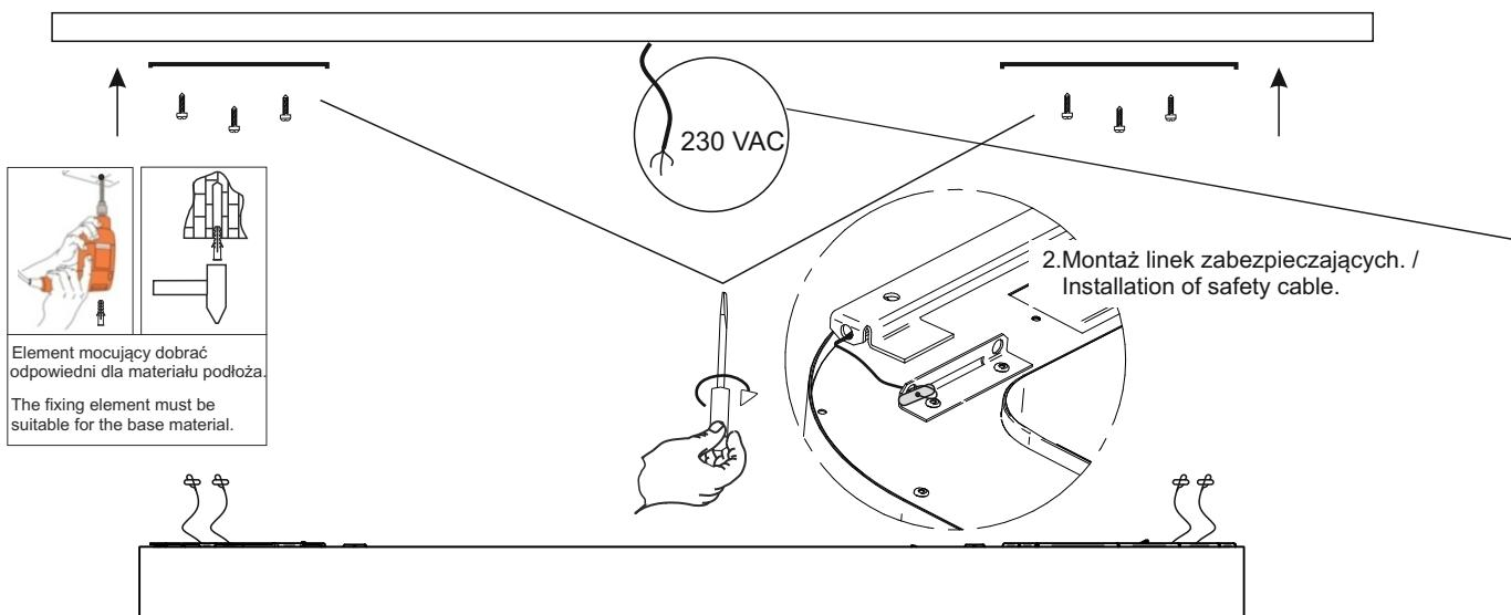
2. Montaż linek zabezpieczających. / Installation of safety cable.
